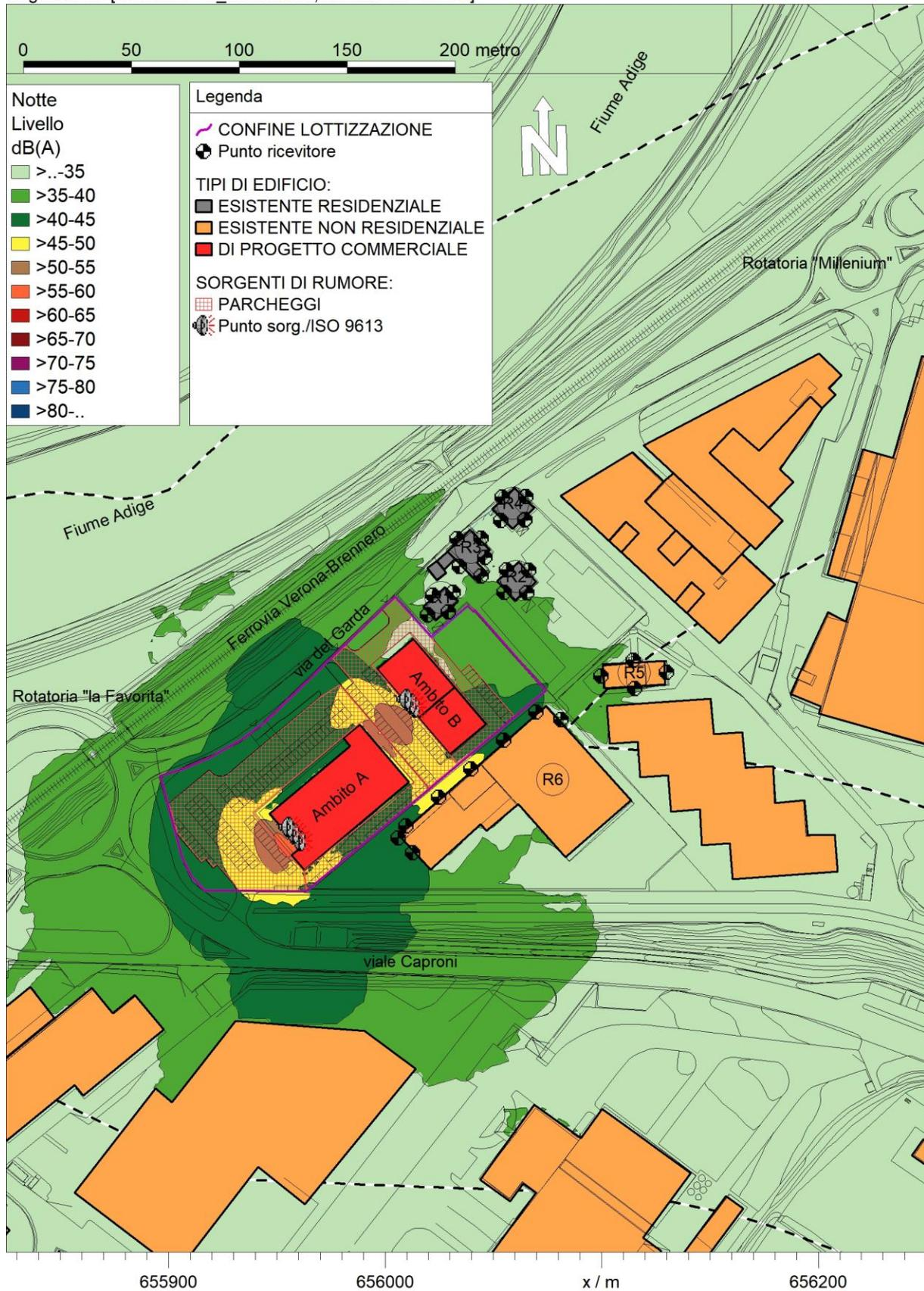
**MAPPA ACUSTICA 4: STATO DI PROGETTO - Livelli di EMISSIONE delle attività commerciali PERIODO NOTTURNO (LAeq ora di picco notturna – dBA)**
