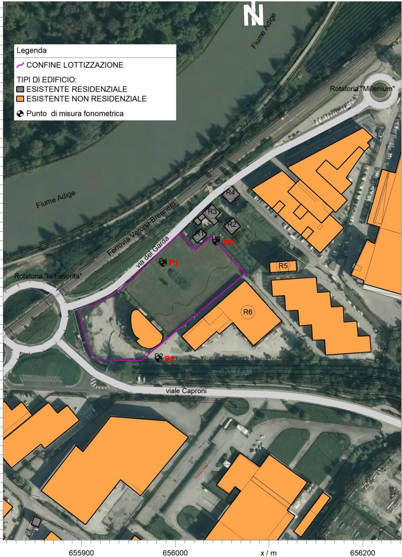
Figura 4: Planimetria dei punti di rilievo fonometrico (P1, P2, P3)
