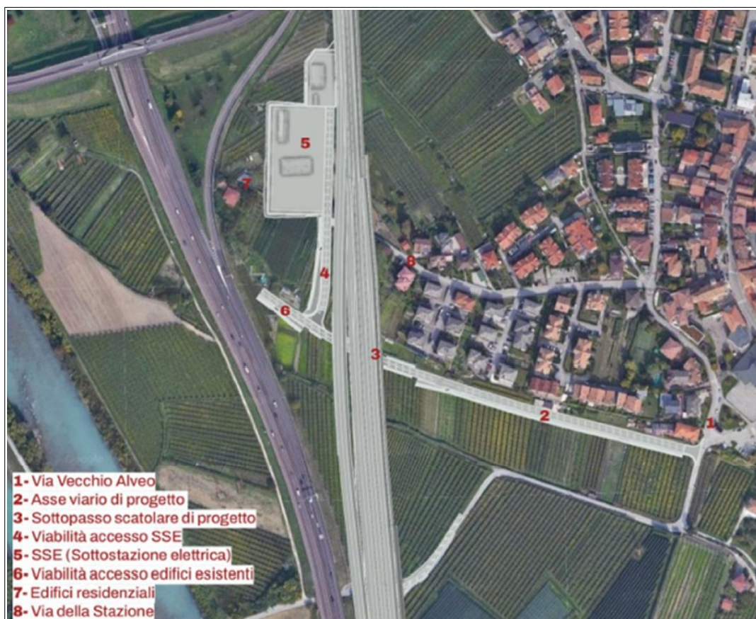
Fig. 12 – Estratto relazione di progetto – Sottostazione elettrica in loc. Marco e opere infrastrutturali complementari
