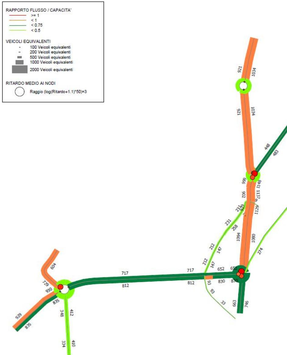
Figura 3.9 - Modello di simulazione del traffico - Scenario BASE - flussogramma con rapporto flusso/capacità.
