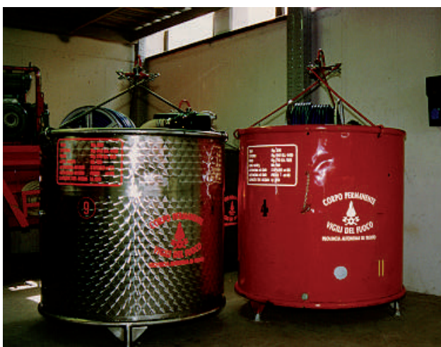
Figura 9.3 - Moduli elitrasportabili, formati da serbatoio, motopompa e naspo
