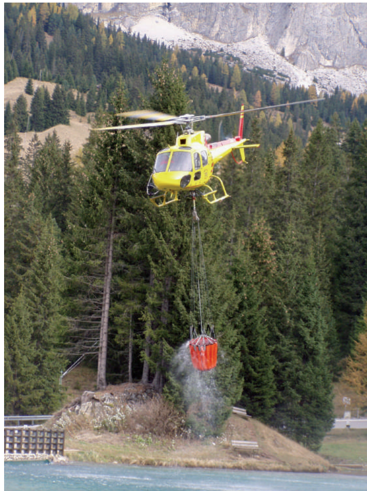
Figura 9.2 - Prelievo da torrente con l'uso del secchio baricentrico
