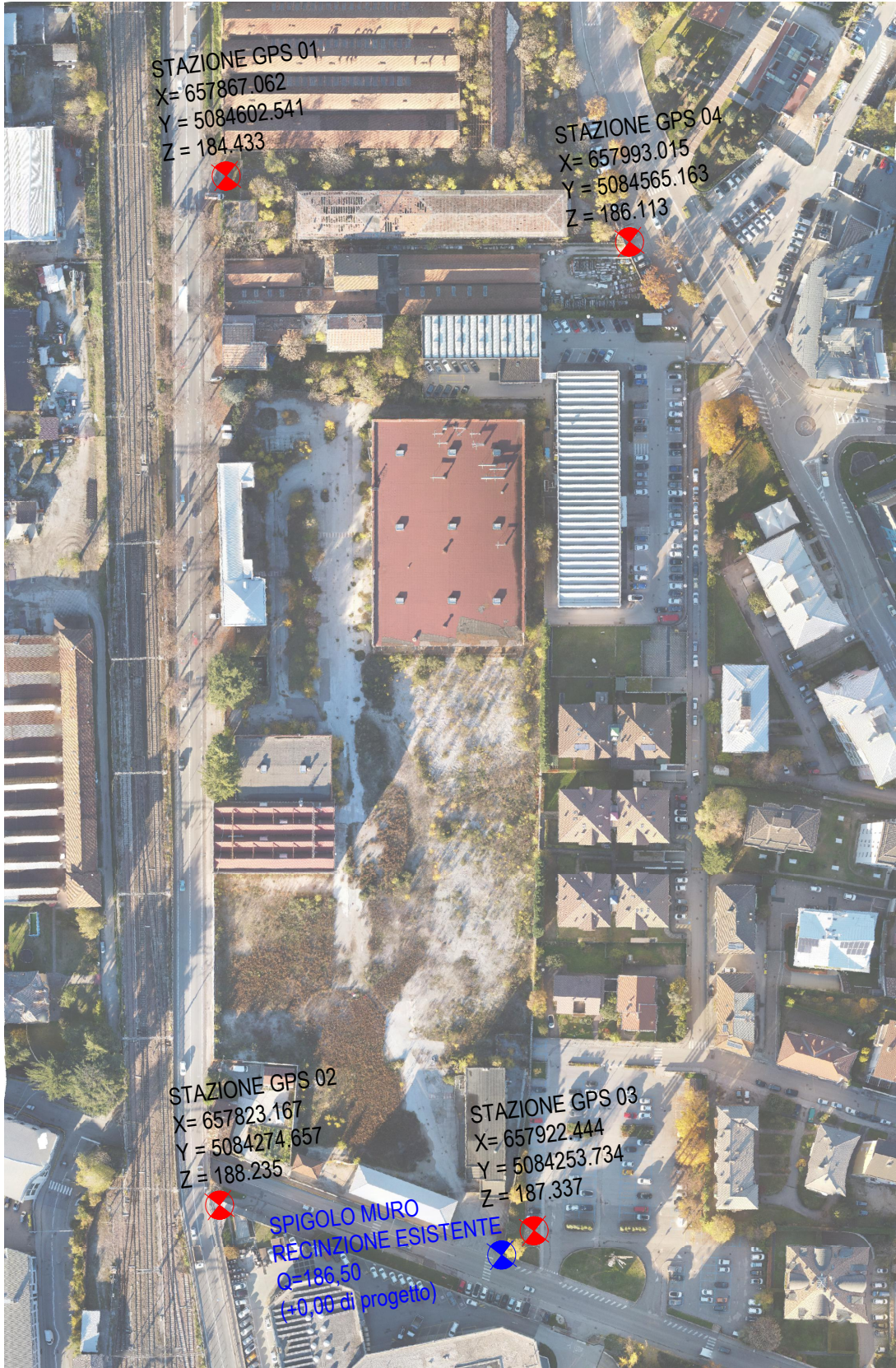
PLANIMETRIA GENERALE - INDIVIDUAZIONE STAZIONI GPS CON CAPISALI DI RILIEVO scala 1:2000
