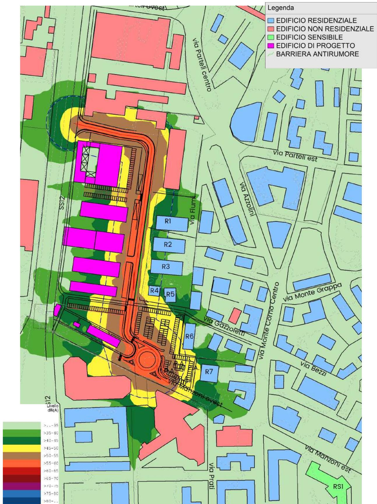
Figura 10: Mappatura acustica di progetto dei livelli equivalenti  $LA_{eq}$  di immissione in dBA e relativi alla nuova infrastruttura con interventi di mitigazione. Periodo di riferimento notturno, compreso fra le 22:00 e le 6:00.
