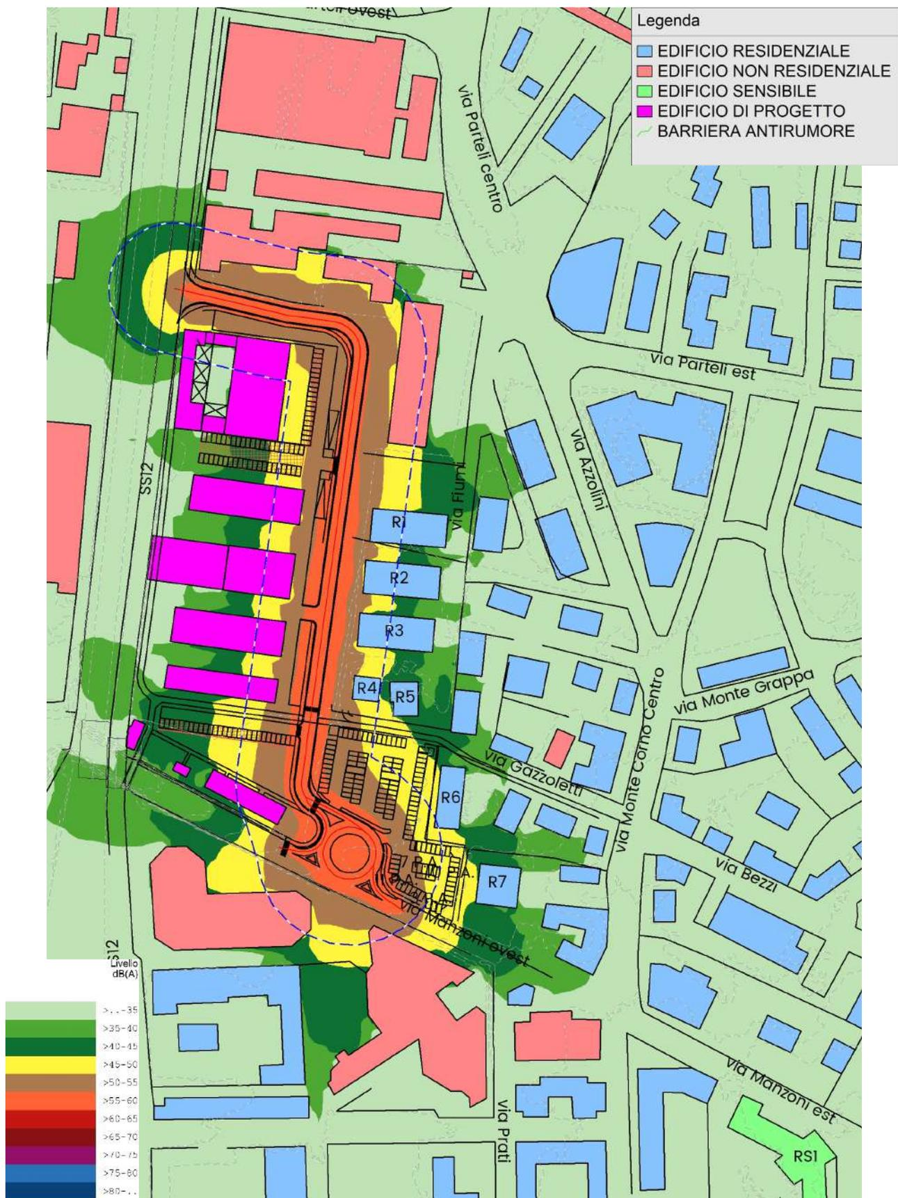
Figura 6: Mappatura acustica di progetto. Sono rappresentati i livelli equivalenti  $LA_{eq}$  di immissione espressi in dBA e relativi alla sola nuova infrastruttura. Periodo di riferimento notturno, compreso fra le 22:00 e le 6:00.
