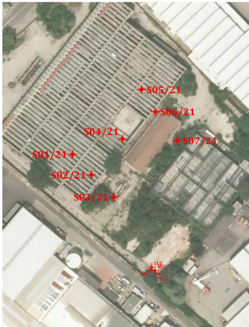
In particolare il foro I12 è stato attrezzato per la misura dei livelli di falda con inserimento di un tubo fessurato su tutta la lunghezza; a fine sondaggio, il pelo libero della falda acquifera è stato misurato alle profondità di 6.4 metri.
