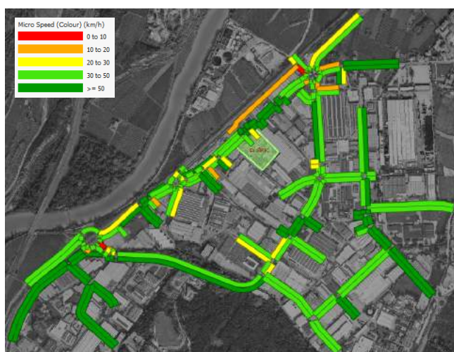
Figura 36 – Scenario di Progetto 02- Velocità media (17:00-18:00)
