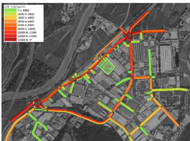
Figura 43 Emissioni in g/km prodotte dai veicoli circolanti su ciascun arco della rete viaria. SCENARIO DI PROGETTO CON RIDUZIONE DELL'1% DELLA DOMANDA AUTO
