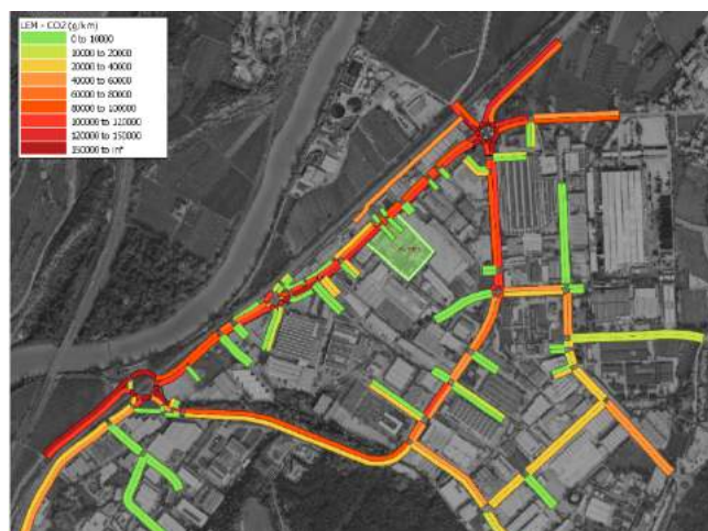
Figura 44 Emissioni in g/km prodotte dai veicoli circolanti su ciascun arco della rete viaria. SCENARIO DI PROGETTO CON RIDUZIONE DELL'4,5% DELLA DOMANDA AUTO
